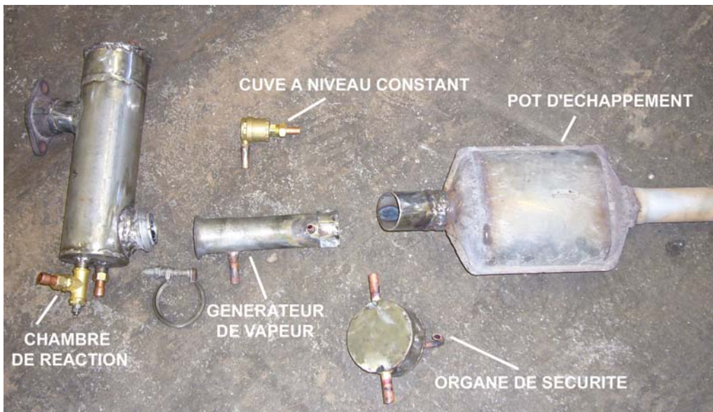
Vue d'ensemble des divers éléments réalisés en atelier
