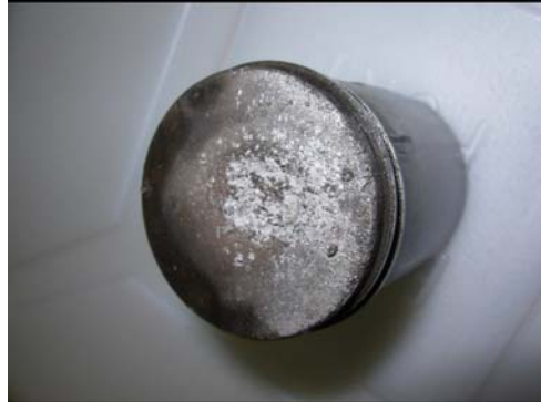
Tête de piston piquée par des gouttes d'eau
